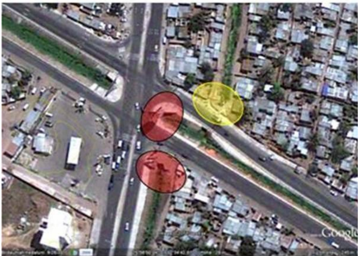
Figura 3-3: Confluência dos 3 principais canais abertos que cruzam a Av. Joaquim Chissano / Av. Acordos de Lusaka (círculo amarelo: saída da sub-captação modelada; círculos vermelhos: canaletas adjacentes com influência na saída modelada)
